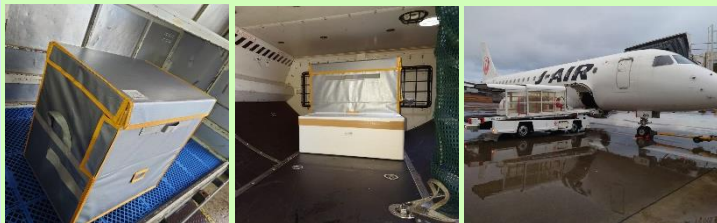
航空機材が小さいため航空コンテナを積むことが出来ずいたが、小型機用専用保冷コンテナを開発したことで航空便再開に向けて大きく動き出した。
